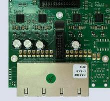
Módulo de interfaz de línea telefónica 8 FXS
